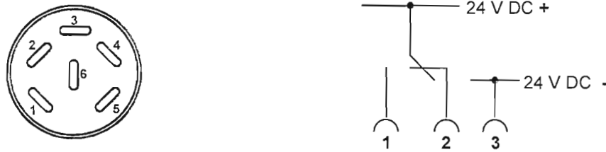
Abbildung 13: Pinbelegung der DIN Buchsen (15) und (16)
